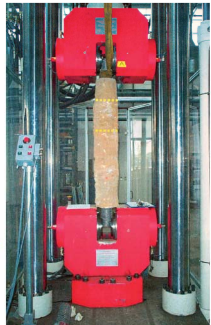
Испытание извлеченных из грунта свай ТИТАН на образование трещин в цементном теле, ТУ Мюнхен Проф. Др. Цильх, Проф. Др. Шисл
