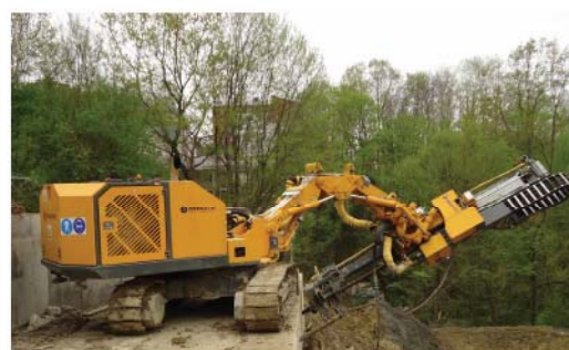
Самоходные буровые установки для бурения всех типоразмеров от ТИТАН 30/16 до ТИТАН 103/51, производителей Klemm, Hütte, Interoc, Morath итд.
