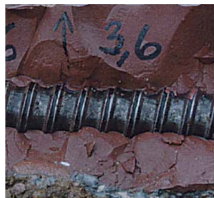
Разрез извлеченной из грунта анкерной сваи ТИТАН 30/11
