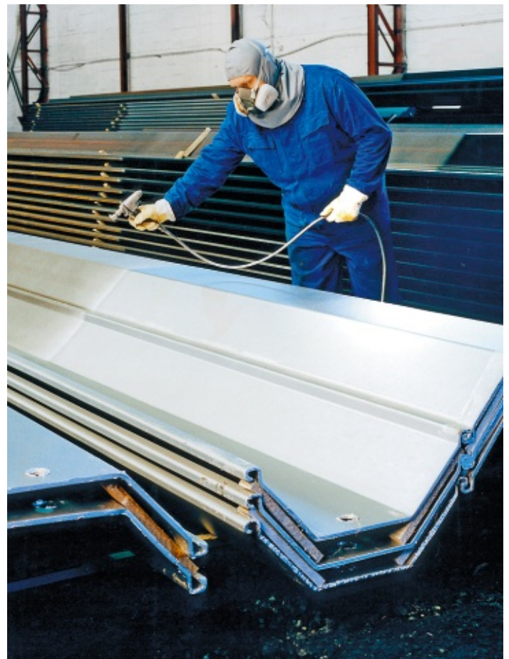
Werkseitige Spundwandbeschichtung Factory coating of sheet piling
